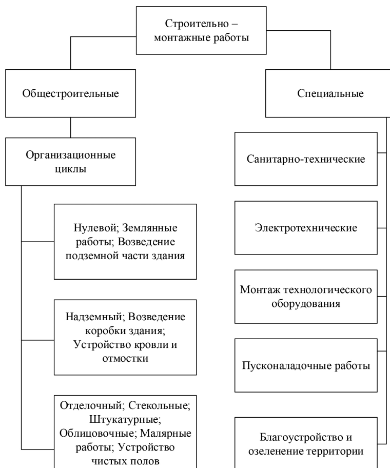
Строительно-монтажные работы при строительстве ТЭС
