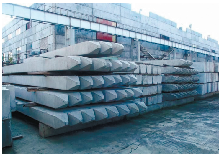
Рис. 4. Готовые железобетонные сваи
